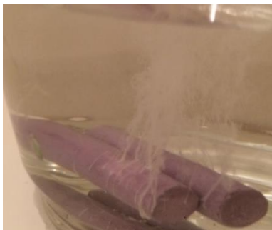
Figure n° 6 : Bulles plus petites provenant de craies dans du vinaigre, à comparer avec celles provenant de coquilles d'œufs de la figure n° 5. (Source : ESA CCI)
